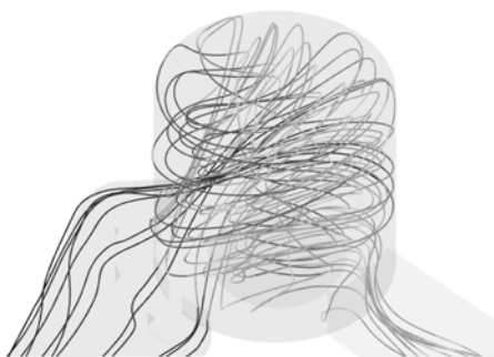
图 5 下止点附近缸内流线 (曲轴转角为 176.5^\circ , aTDC)
